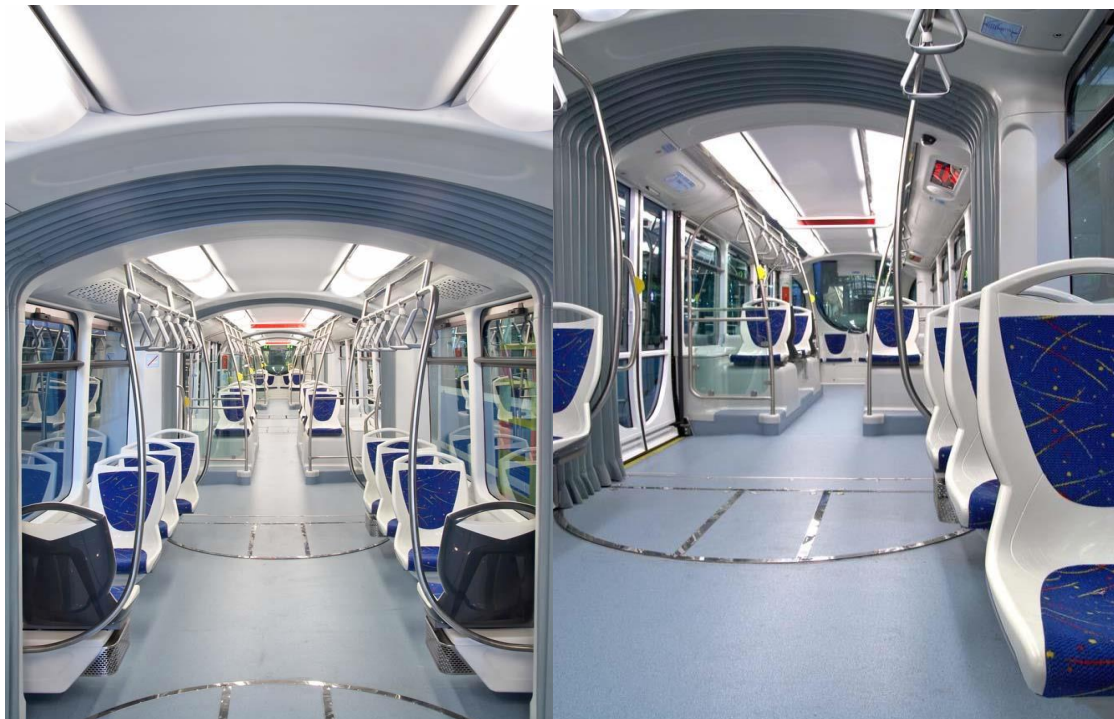
Slika 4 : unutrašnjost 100 % niskopodnog tramvaja
